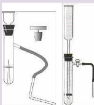
Рис. 7. Прибор для получения и собирания газов
