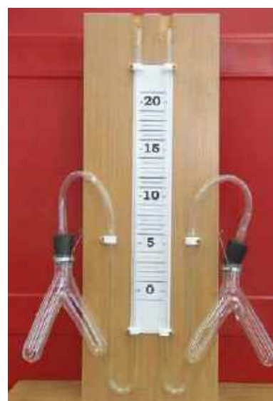
Рис. 19. Прибор для определения скорости химических реакций
